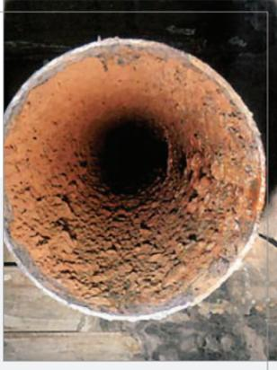
Идея нанесения цементно-песчаного покрытия на внутреннюю поверхность водопровода возникла ещё в 1836 году во Франции. Применять этот метод стали лишь с 1922 года после изобретения метода разбрызгивания.
